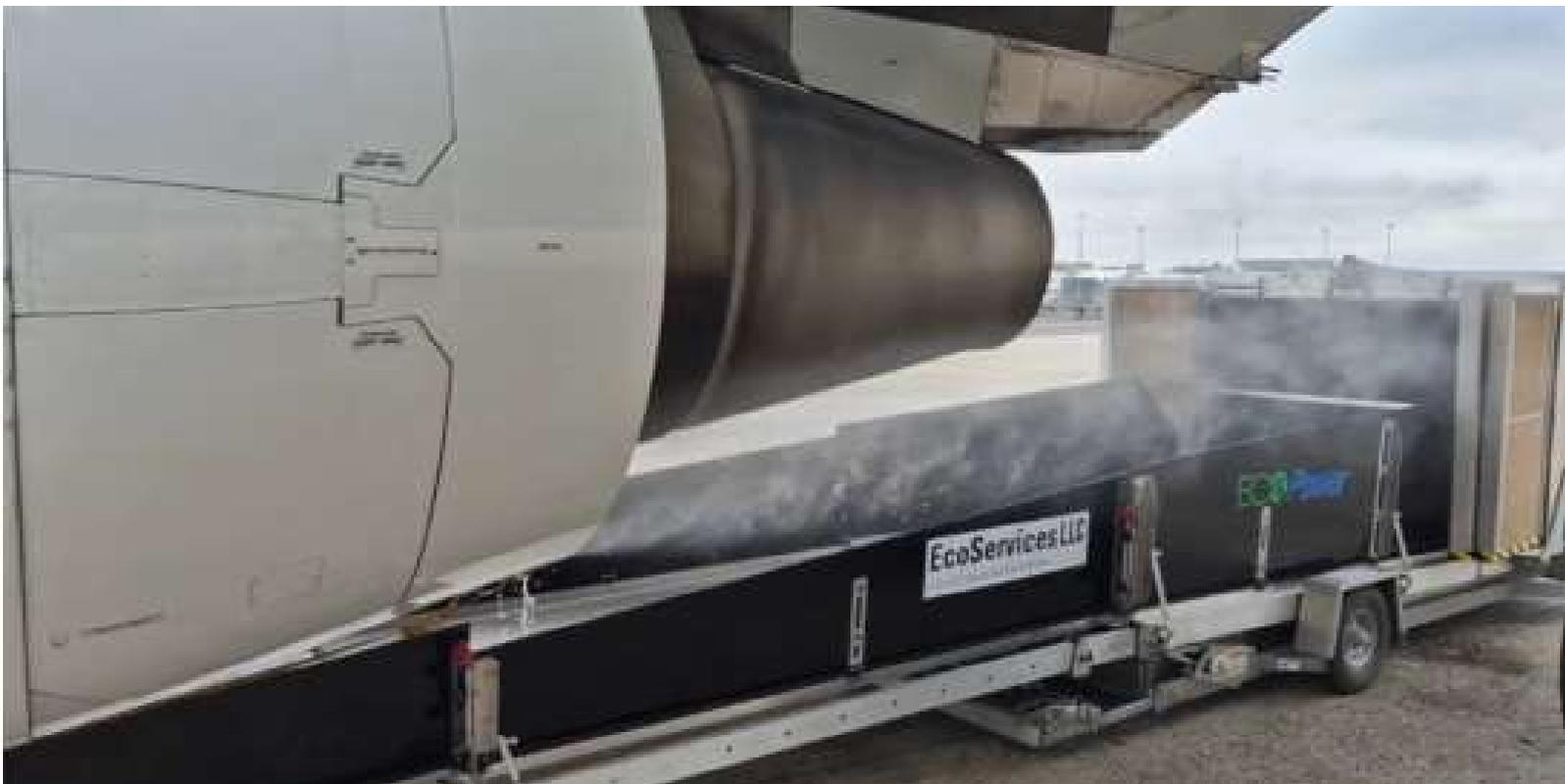
*Nettoyage d'un moteur CFM56 d'Amelia avec la technologie ECOPower*
